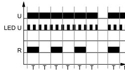
Включение напряжения питания  $U$ , начинает отсчёт установленного времени  $T$  с одновременным включением исполнительного реле  $R$ . После отсчёта времени  $T$ , исполнительное реле  $R$  возвращается в начальное состояние и начинается повторный отсчёт времени  $T$ . Циклическая работа реле длится до момента выключения напряжения питания  $U$ .
