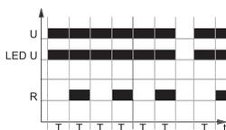
Включение напряжения питания  $U$ , начинает отсчёт установленного времени  $T$ . После отсчёта времени, наступает срабатывание исполнительного реле  $R$  и снова начинается отсчёт времени  $T$ . Цикличная работа реле длится до момента выключения напряжения питания  $U$ .
